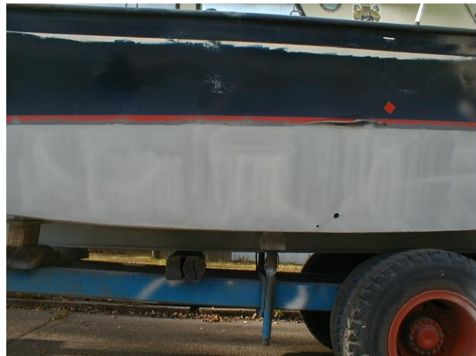
Unterschiff: sandgestrahlt u. verzinkt mit 90 – 120 µ Reinzink
