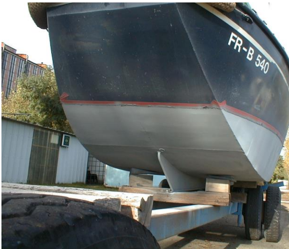
Unterschiff: sandgestrahlt u. verzinkt mit 90 – 120 µ Reinzink
