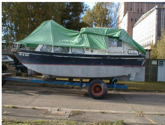
Unterschiff: sandgestrahlt u. verzinkt mit 90 – 120 µ Reinzink
