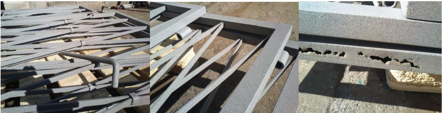
Nach dem strahlen nach SA 2,5
