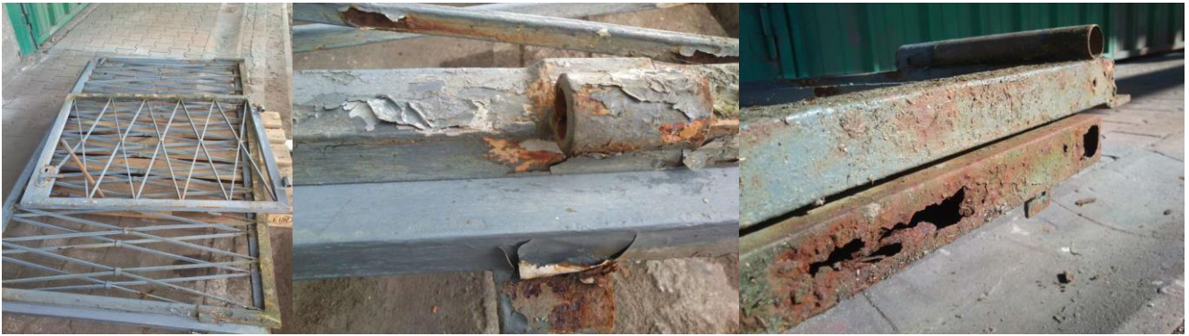
Nach dem strahlen nach SA 2,5
